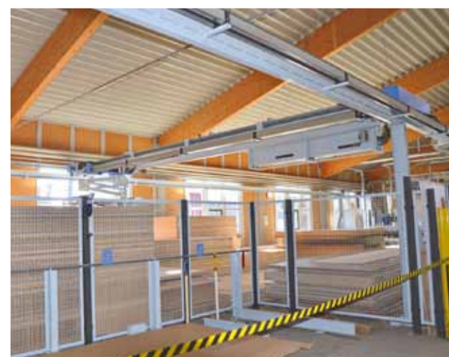
Automatický sklad desek TLF 211 může pojmout a spravovat všechny rozměry desek největšímu standardnímu formátu 5 600 x 2 200 mm.
