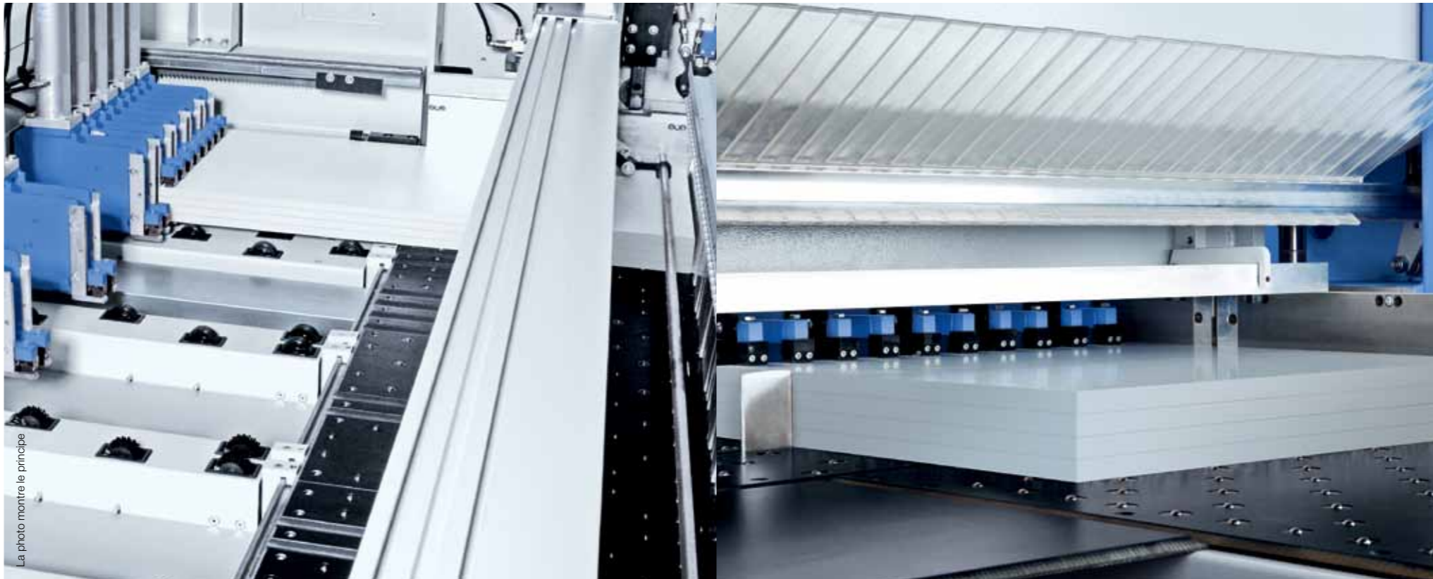
Equipement spécial : pinces de serrage sur positions 2 et 4, panneau rainuré
