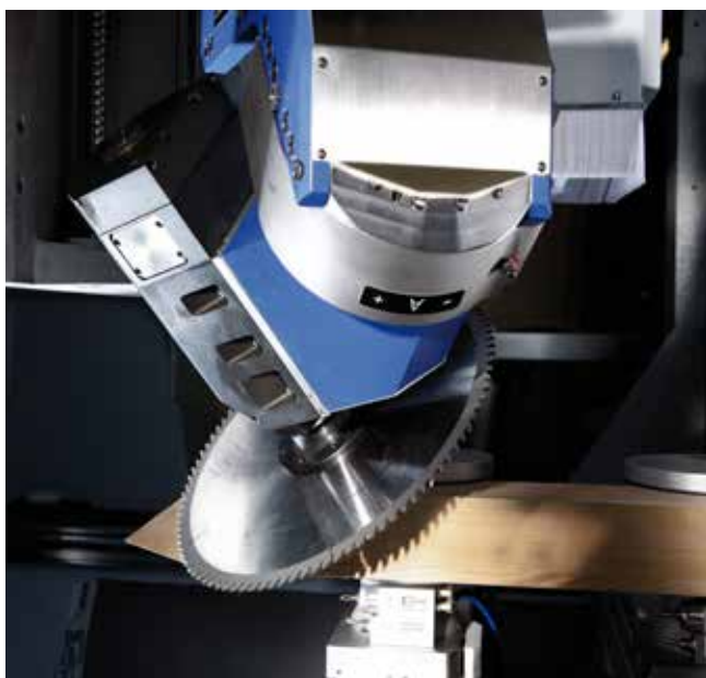
5osé vřeteno frézky DRIVE5CS/C+ – s výkonem 10 kW (volitelně 12 nebo 15 kW) a regulovanými otáčkami vřetena až 24 000 1/min pro vysoký točivý moment i při nízkých otáčkách.
