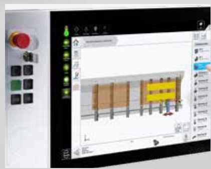
Druhý obslužný terminál (doplňkové vybavení) pro optimální střídací provoz bez zbytečných pracovních tras – optimální u strojů s velkým pracovním polem. Volba programu a obsazení stroje je možné na obou stranách.
