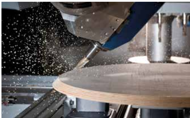
Frézování zkosené hrany na desce stolu
