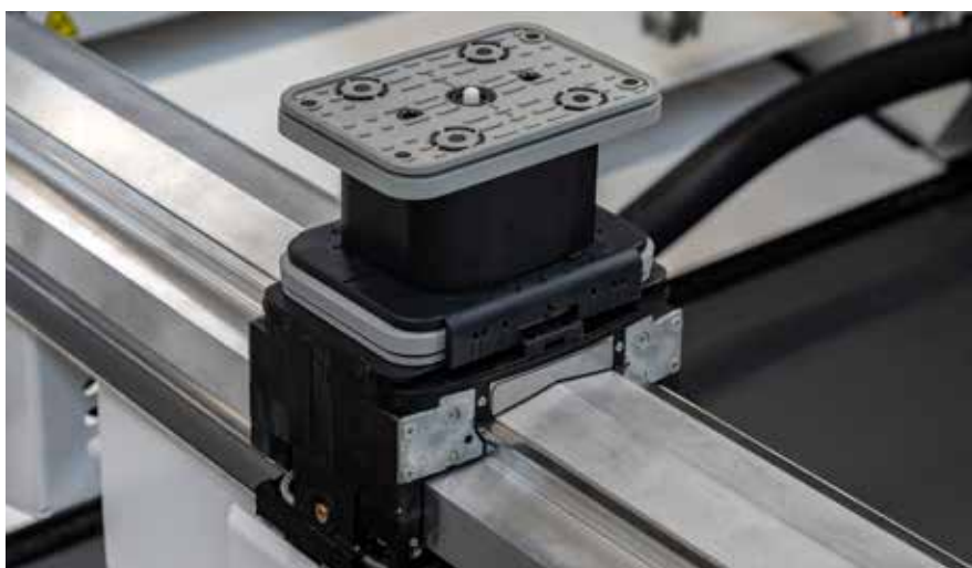
Vakuový držák se snímacím ventilem – neobsazená přísavná zařízení mohou zůstat na základně. Montážní výška 100 mm
