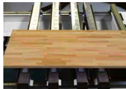
Laserová projekce upínacích prostředků a obrysu obráběného dílce pro optimální využití a jednoduché pokládání polotovarů, které nelze vyrovnat podle dorazů.
