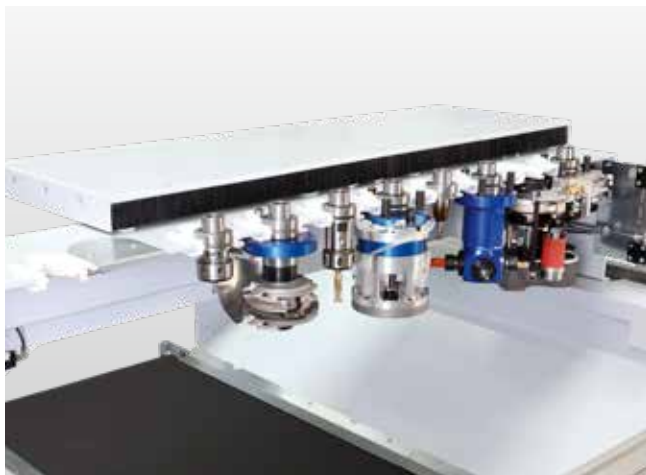
8místný lineární měnič s místem pro předávání nástrojů, namontovaný na straně. Volitelně lze také integrovat místo Pick-up pro agregát easyEdge.
