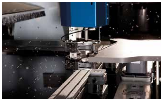
Dokonalá povrchová úprava hran díky kombinovanému agregátu lícovací frézky / dočišťovacímu agregátu s naváděním
