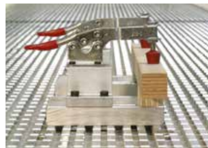
Upevnění speciálních upínacích prostředků Hliníkový mřížkový stůl s rybinovitými vodicími prvky zaručuje přesné upevnění upínacích prvků tvarovým stykem
