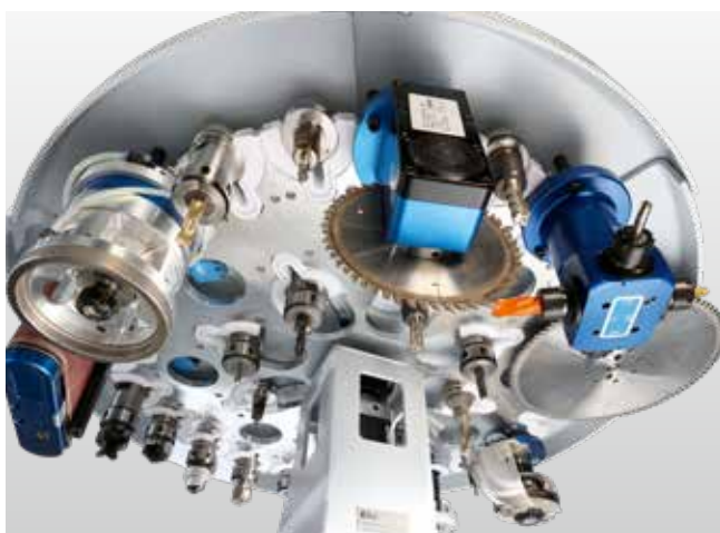
32místný talířový měnič – uspořádání nástrojů ve vnitřním a vnějším kruhu. Pro nástroje a agregáty o průměru až 200 mm a pilový kotouč o průměru až 350 mm (ve vnějším kruhu).
