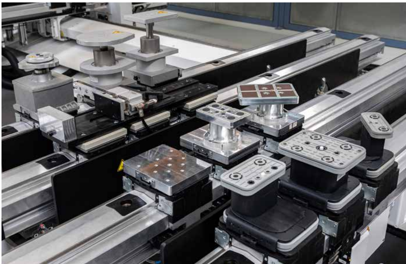
Vakuový držák se snímacím ventilem – neobsazená přísavná zařízení mohou zůstat na základně. Montážní výška 100 mm
