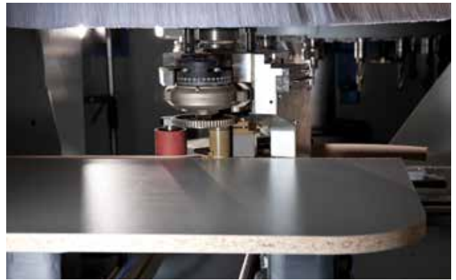
Olepovací agregát easyEdge pro racionální olepování tvarových dílců
