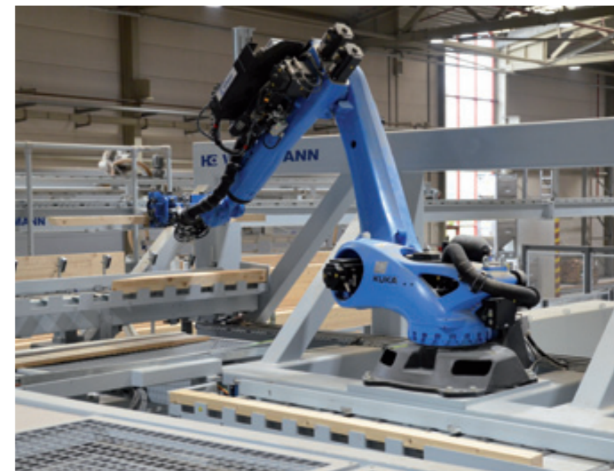
Bild Seite 42: Je nach dem, ob es sich um Gurte, Stiele oder bspw. Brüstungshölzer handelt, erfolgt das Ablegen quer, längs oder diagonal.
