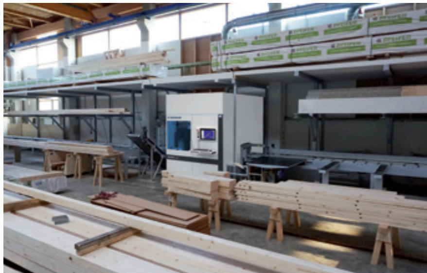
Bild: Das Herzstück der Abbundhalle ist die Abbundanlage BEAMTEQ B-660.
