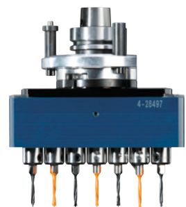
3 Perçage de rangée de trous pour tablettes
