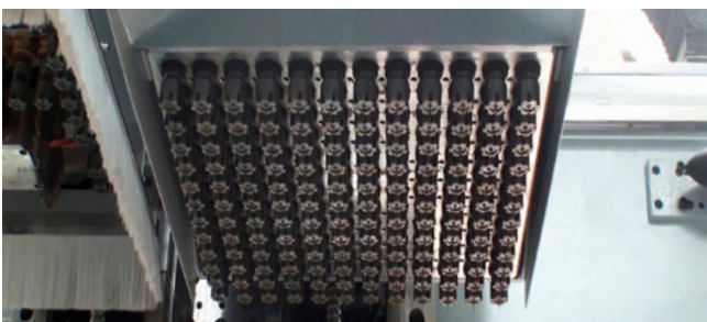
Agrégat de perçage 144 broches
