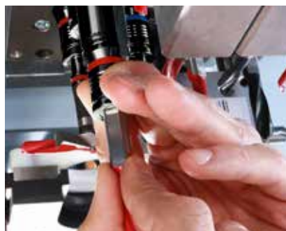
Patentovaný systém pro rychlou výměnu vrtáků bez nástrojů ke zkrácení přípravných časů.
