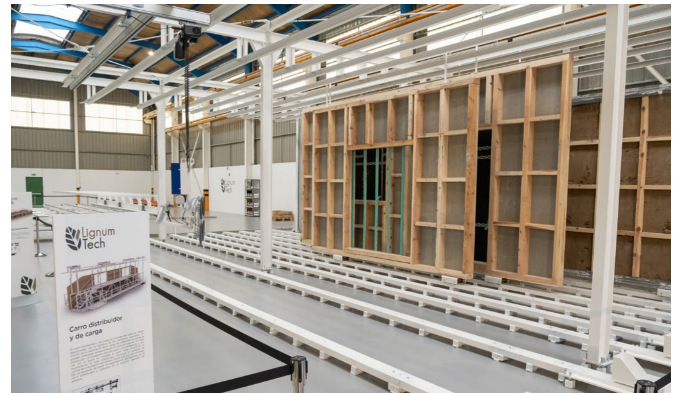
Bild: Die Produktion von LIGNUM TECH hat eine Fläche von 10.000 m 2 . Dort können jährlich 175.000 m 2 Fassadenelemente hergestellt werden.
