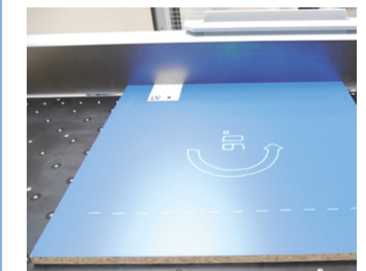
Mensch-Maschine-Interaktion: Die Säge reagiert auf Aktionen des Bedieners
