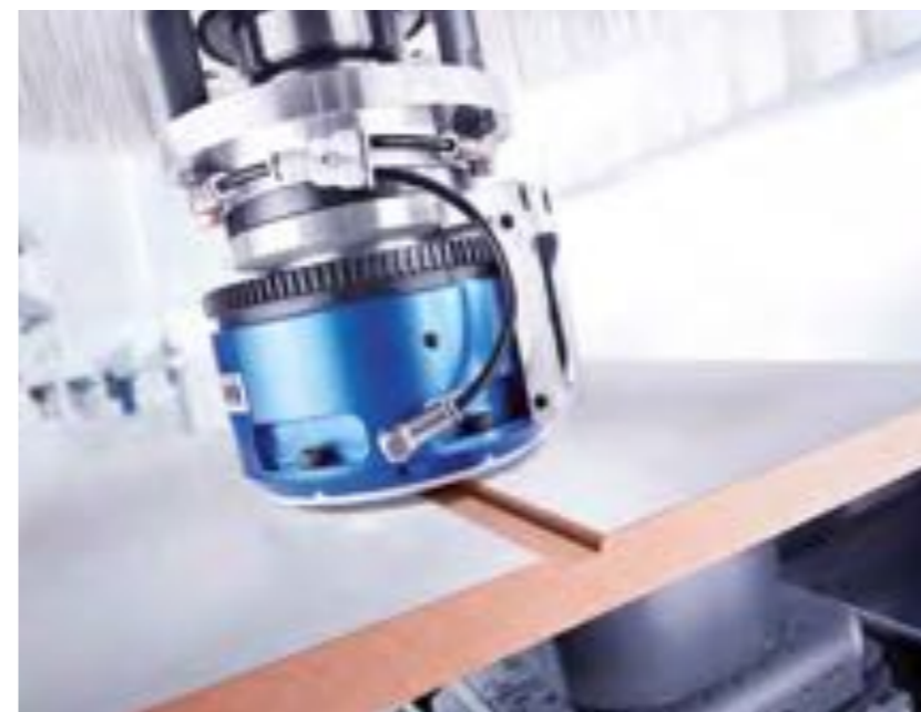
Das Tastaggregat FLOATING VC kann mit Drehzahlen von bis zu 24.000 min -1 betrieben werden.
