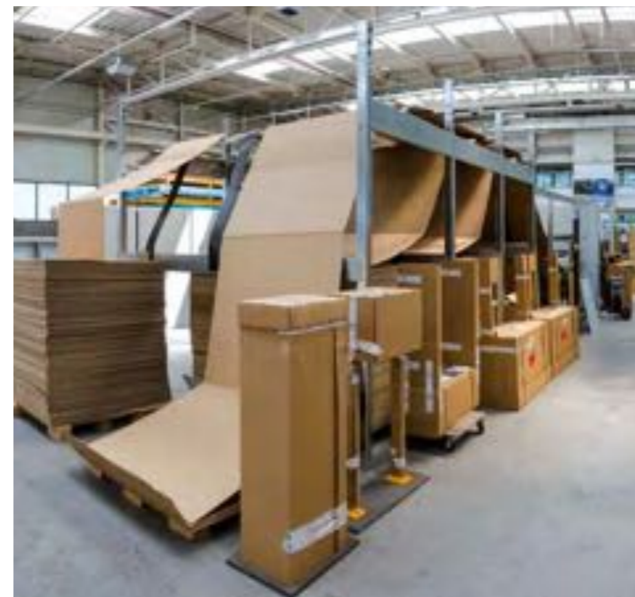
Mehrere Kartonmagazine erlauben den Einsatz von unterschiedlichen Kartondicken und -grössen.
