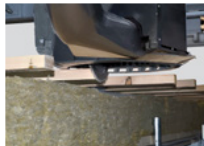
Форматирование обрешетки стропильных элементов
