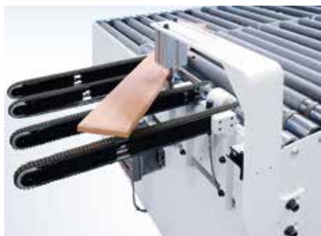
Butées rotatives pour les pièces étroites commandées par capteur (option)
