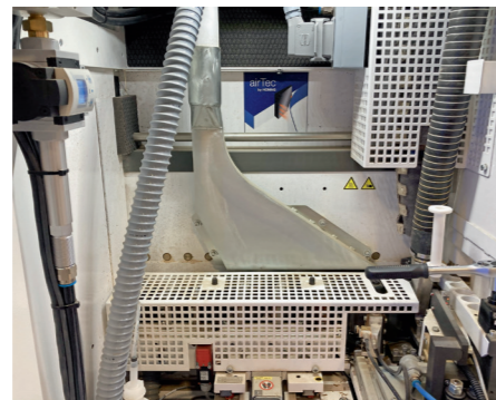
Mit dem Airtec-Aggregat lässt sich eine hochqualitative Kante mit „Nullfuge“ erzielen.
