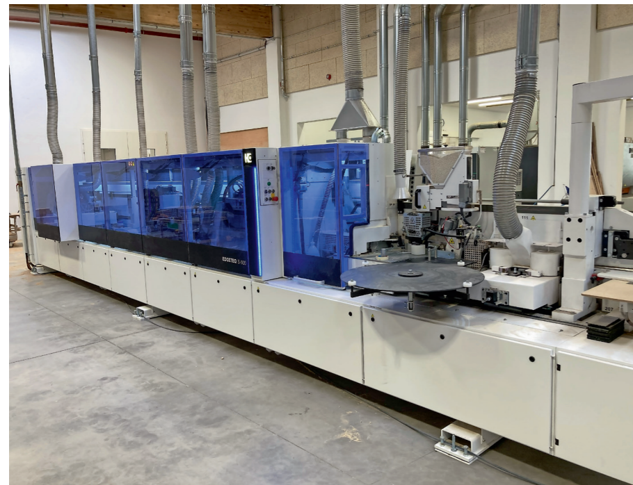
Oben: Die Edgeteq S-500 profiLine bei der Tischlerei Decker ist neben dem Airtec-System auch mit speziellen Hightech-Aggregaten ausgestattet.
